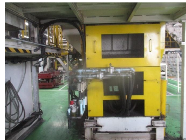
รูปที่ 2-33 Silencer ที่วาล์วควบคุมกระบอกลมเครื่องทุบ
