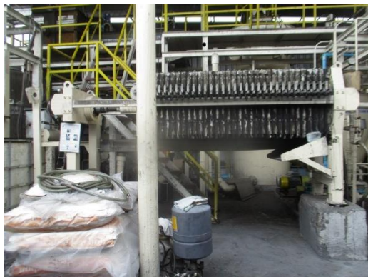
รูปที่ 2-50 พาเลทรองรับการรีดตะกอนจากระบบบำบัดน้ำเสียทางเคมี
